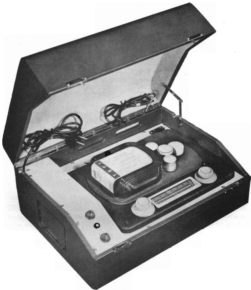
Fig. 6.8 B - Apparecchio a nastro fonografico con amplificatore e altoparlante; è ben visibile la scatola contenente il nastro.
