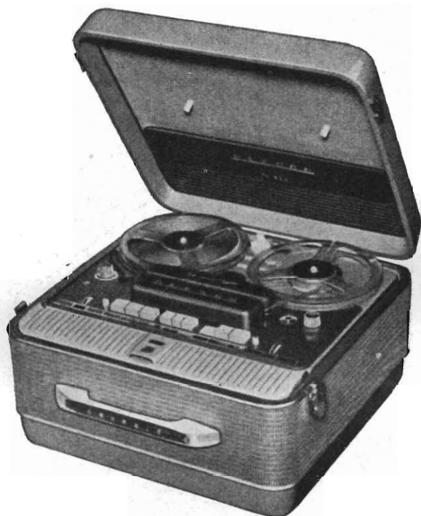
Fig. 13.16 - Esempio di magnetofono con comandi principali e di movimento a tasti, e con inversione automatica della corsa del nastro.
