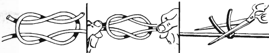
Fig. 12.17. - Utilizzando teste magnetiche di tipo aperto, come indicato dalla fig. 12.14 è possibile congiungere il filo d'acciaio con un semplice nodo, come indicato, ciò che non sarebbe possibile con teste magnetiche del tipo chiuso, come in B) di fig. 12.12.
