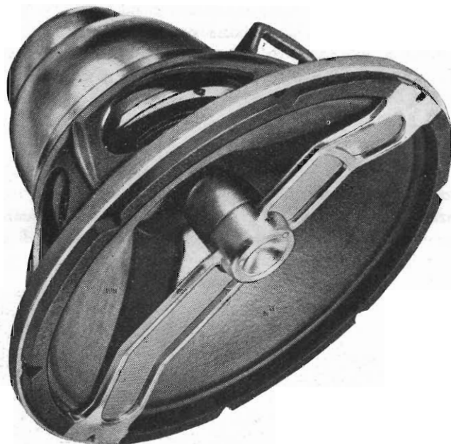
Fig. 3.19. - Altoparlante triassiale, con unità a compressione per frequenze alte posta verso il centro del cono. Corrisponde alle figure 3.17 e 3.18. (Jensen mod. G. 610).
